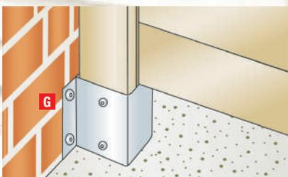
Pour commencer une clôture depuis un mur, utilisez des platines de départ mural. Elles permettent de fixer un poteau de clôture directement sur un mur.
