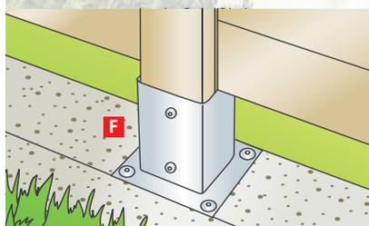
Pour fixer un poteau sur un support maçonné, utilisez des platines à fixer pour poteau bois. Le poteau est solidement fixé par des goujons.
