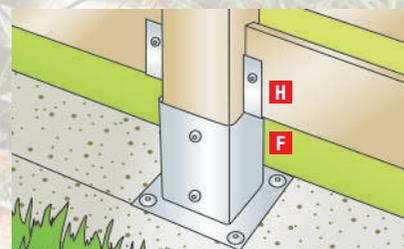
Pour une pose ajourée des lames de clôture, utilisez des supports de traverse. Ils se fixent sur un poteau bois « Ombrone ».
